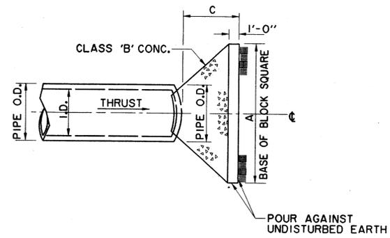
**PLAN OF PLUG THRUST BLOCK**
