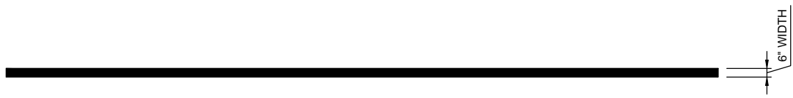
C-107 3 ROADWAY EDGE MARKING SCALE: NONE
