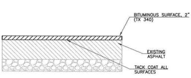
**ASPHALT OVERLAY DETAIL**
