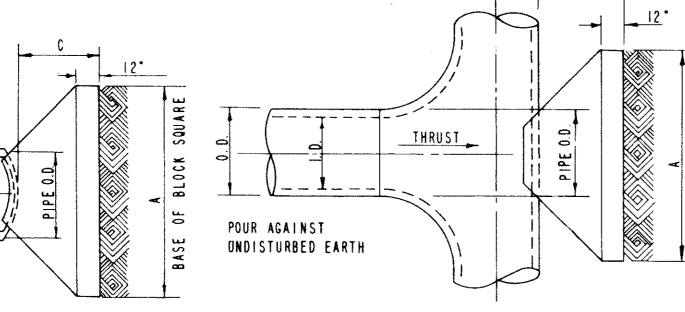
PLAN OF PLUG THRUST BLOCK
