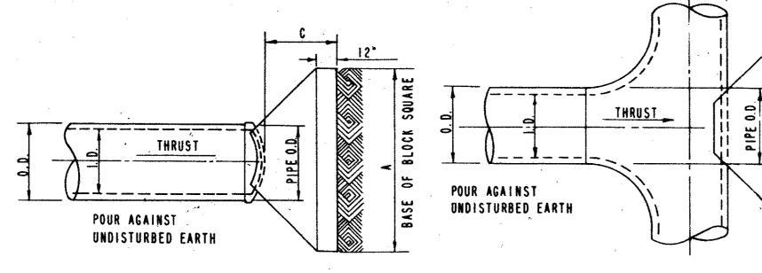
PLAN OF PLUG THRUST BLOCK
