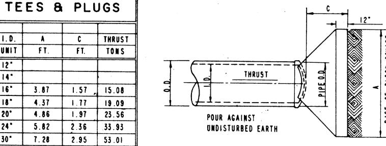
PLAN OF PLUG THRUST BLOCK
