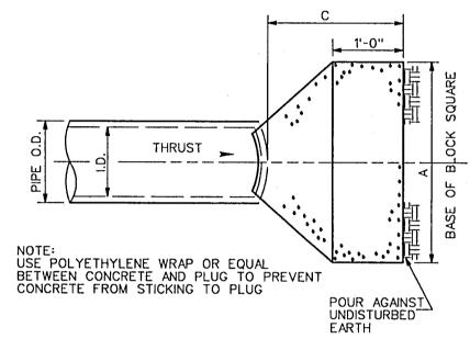
PLAN OF PLUG THRUST BLOCK NTS
